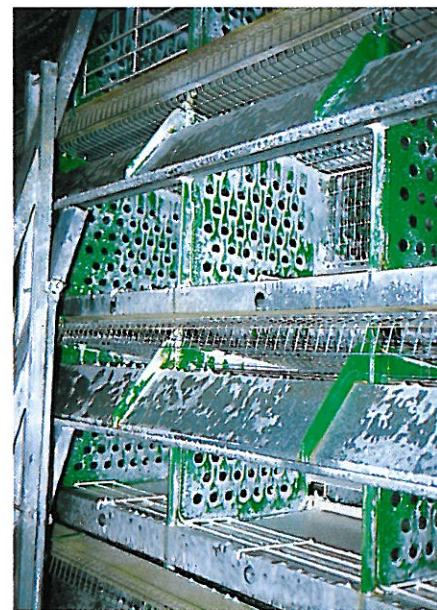
Moussage d'une batterie lors des opérations de lavage
