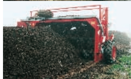
Les retourneurs d'andains, à un ou deux rotors, sont des engins très efficaces pour assurer une bonne aération et une bonne homogénéisation des fumiers de volailles mis à composter.
