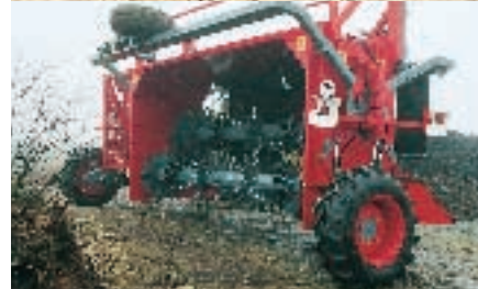
L'utilisation d'un épandeur à poste fixe pour aérer un andain est possible, mais gourmande en temps de travail
