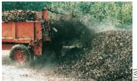
L'utilisation d'un épandeur à poste fixe pour aérer un andain est possible, mais gourmande en temps de travail
